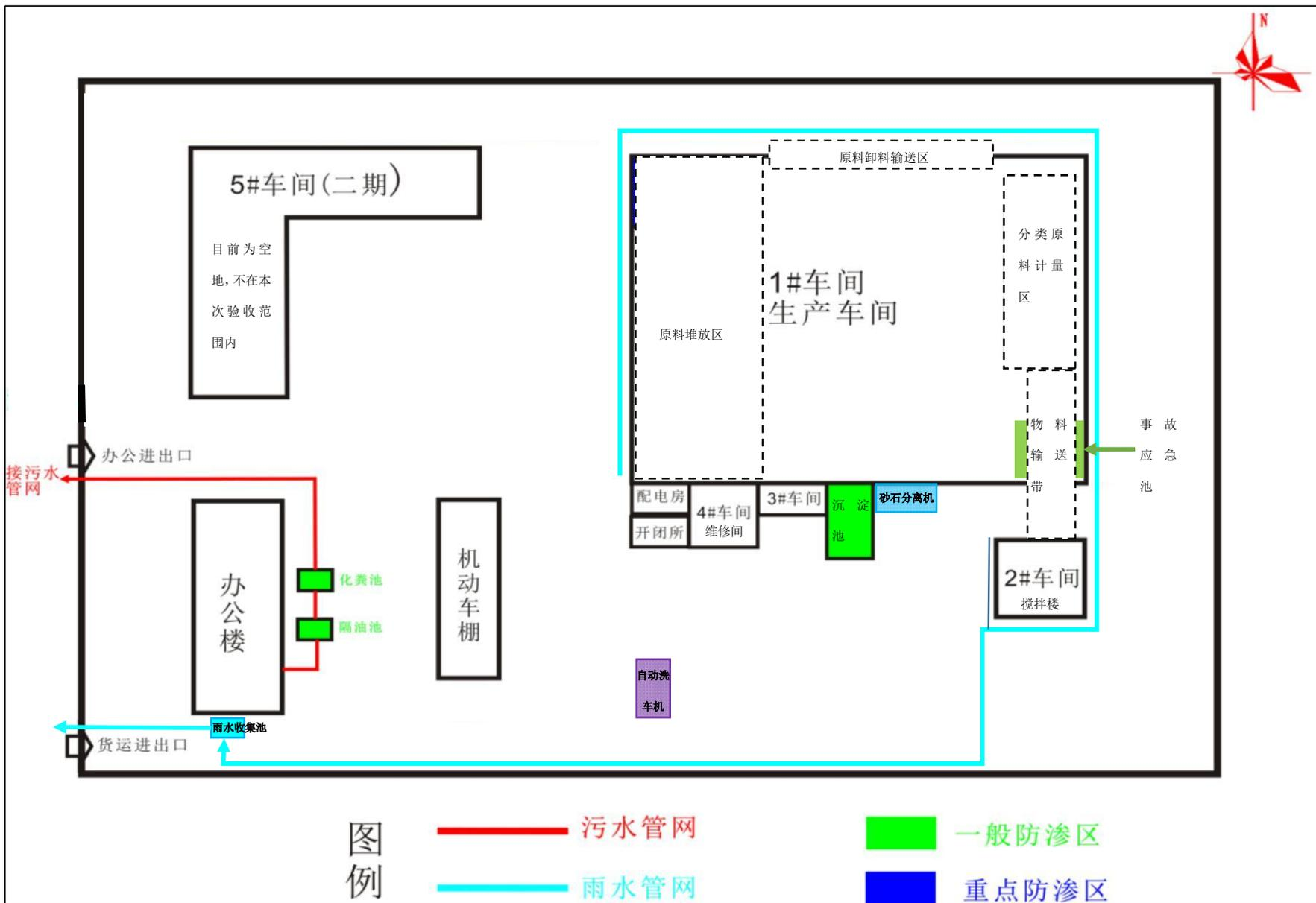
附图3 项目平面布置图、雨污管网及防渗分区图
